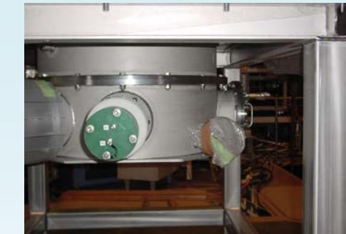
ジャイロトロン管タンクでは、既に対地 20kV の電極が設けられている。
